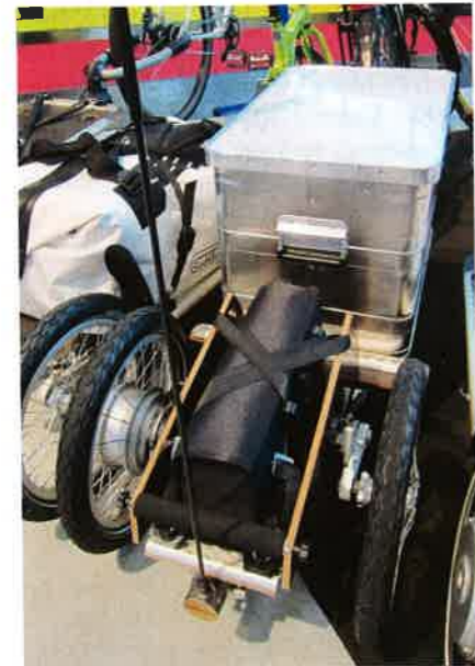
Raffinierte Kombi: elektrifizierter und eigengebremster Aidoo-Anhänger mit 80 Kilo Nutzlast, Transportboxtauglichkeit und hoher Flexibilität
